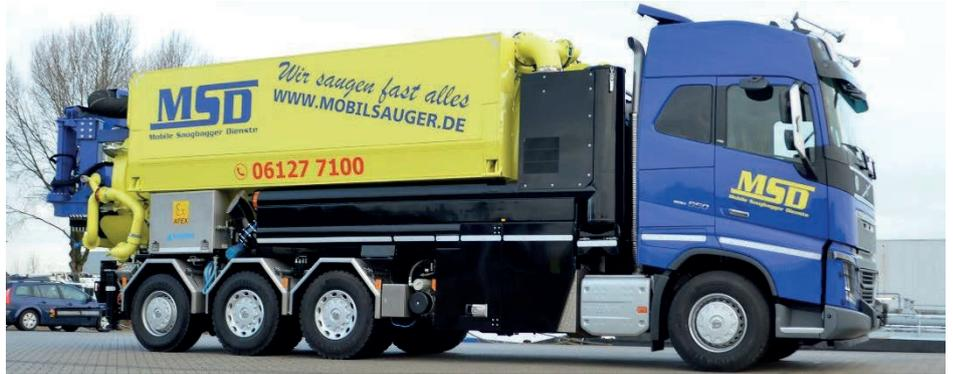
MSD Mobile Saugbagger Dienste, Ihr Dienstleister für alle Arbeiten rund ums Absaugen und Verblasen. Mit unseren Saugbaggern können wir alle Materialien, von flüssig über schlammig, von staubig oder fest saugen. Hauptsächlich werden Saugbagger überall dort eingesetzt, wo nur von Hand gearbeitet werden kann, weil Kabel, Leitungen oder Rohre im Weg sind, der Platz für einen Bagger zu knapp ist oder die Zugänglichkeit eingeschränkt ist.
